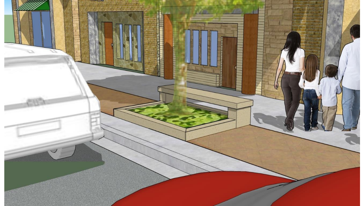
Precast concrete bench along PAR
